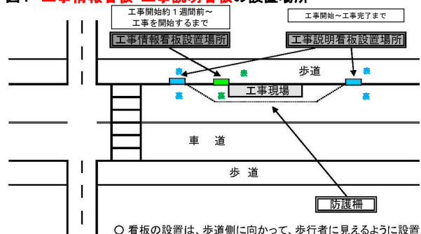
図1 工事情報看板・工事説明看板の設置場所
