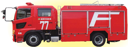
③ タンク車(8台) たくさんの水をつんで火災現場にもっとも近づき、消火にあたります。(この車には3トン~8トンの水をつんでいます。)
