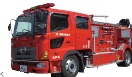
● 化学車(2台) 水では消えない油火災のとき、あわを使って消火します。
