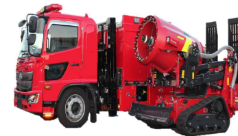
● 特別高度工作車(1台) トンネルなどの火災のとき、煙や有毒ガスなどを風のか力で外に出します。
