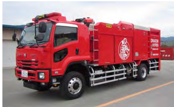
大型放水砲搭載ホース延長車
