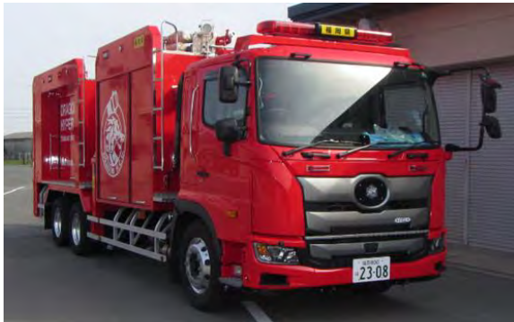
大容量送水ポンプ車
