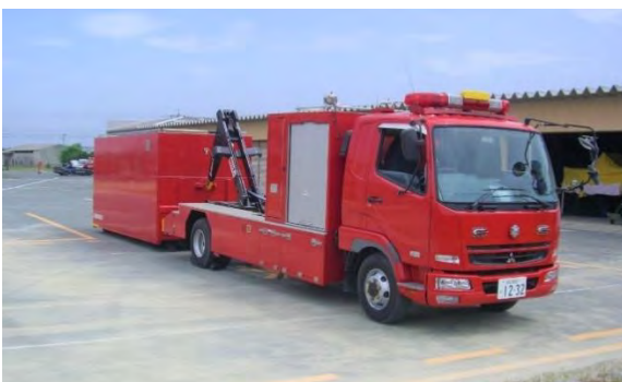
大型除染システム車
