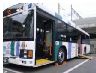
乗降口の段差を低くして乗り降りをしやすくしたノンステップバス
