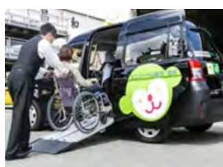
広い乗降口、手すり、スロープが設置されたユニバーサルタクシー
