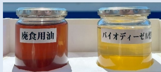
左：市内で回収した廃食油、右：精製したバイオ燃料
