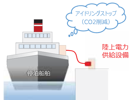
船舶への陸上電力供給
