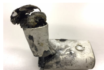
発火原因となった加熱式たばこ (リチウムイオン電池内蔵) 出典：(公財)日本容器包装リサイクル 協会HP
