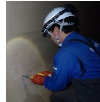
テストハンマーによる打音調査
